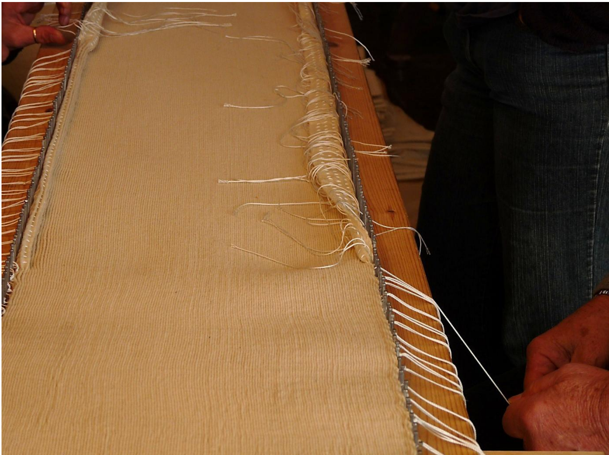
Kypervevet ullstoff med innvevde trekktråder har blitt trukket sammen og lagt på en bordplate med en spikerrekke på hver side. Nå blir trådene knytt fast til spikerne for å holde plisseringen på plass
